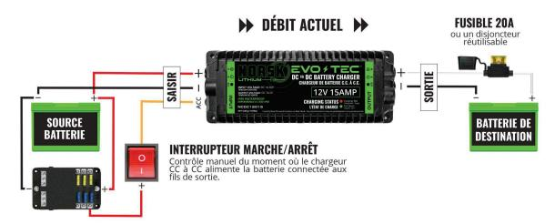
**AVERTISSEMENT**: La connexion en polarité inversée des fils du corps du chargeur aux bornes de la batterie peut provoquer un court-circuit et causer des dommages importants et irréparables au chargeur de batterie et à la batterie. **Les dommages de ce type sont PAS couvert par la garantie**.
